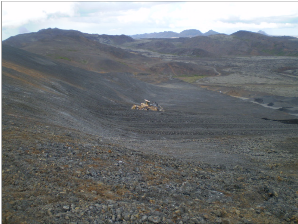
Mynd 2.1 Stærsta jarðýta landsins ýtir efni fram af fjallinu í Vatnsskarðsnámu (mynd: Mannvit, nóv. 2007).
